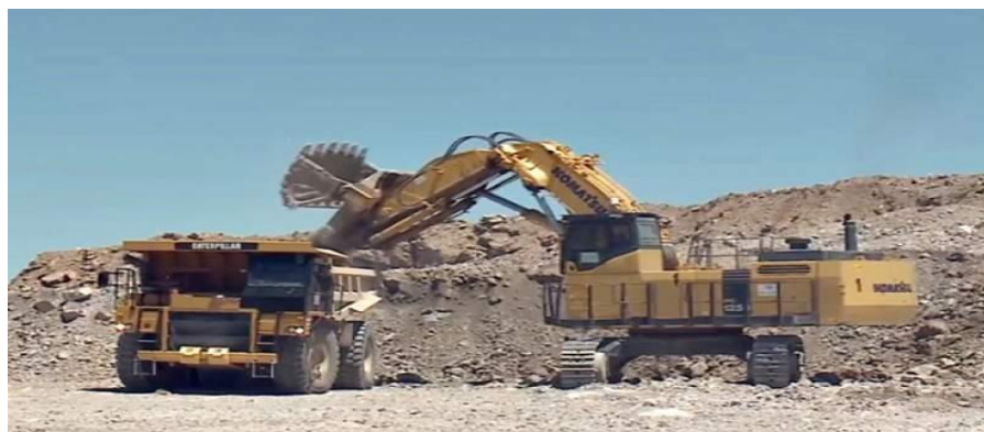
2.4 сурет – Komatsu PC1250-7 эксковаторымен САТ-773Е автосамосвалына тиеу жұмысы
